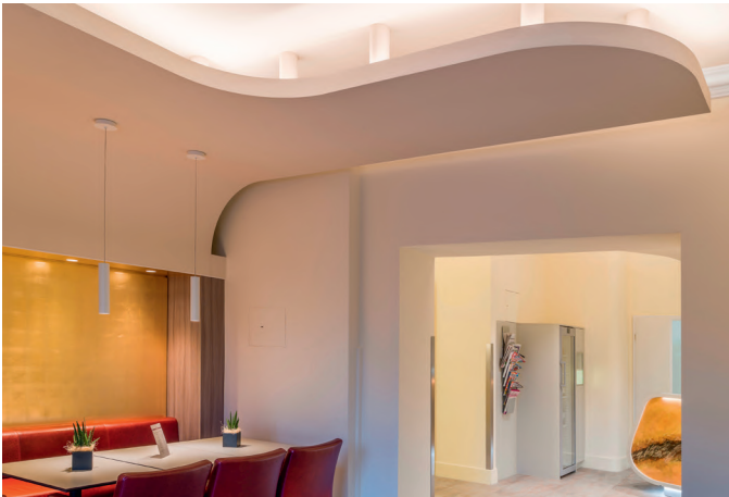
Помещение для завтрака было реконструировано путем сооружения потолка и ниш для сидения с использованием технологии сухого строительства и расширено зоной для отдыха.
