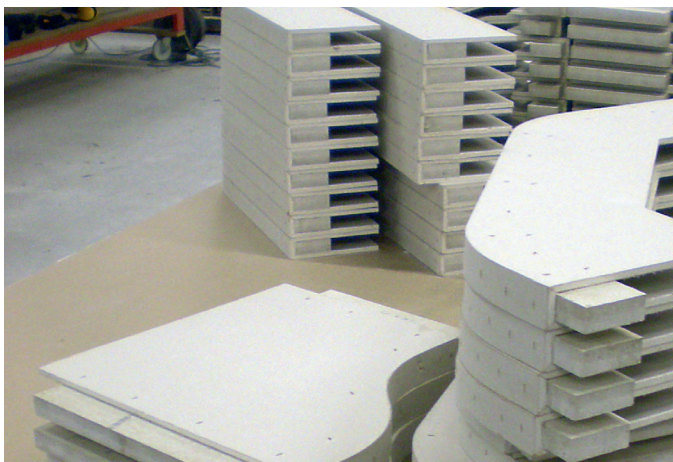
Ламельный элемент в стадии предварительного изготовления: предварительно изготовленные боковые элементы ламелей с отделкой гипсоволокнистыми плитами толщиной 18 мм
