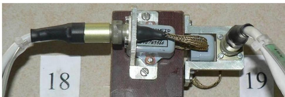
Рисунок 9. Измерительно-вычислительного комплекса МІС - 036 и акселерометр АТ 1105.1 – 5А.
