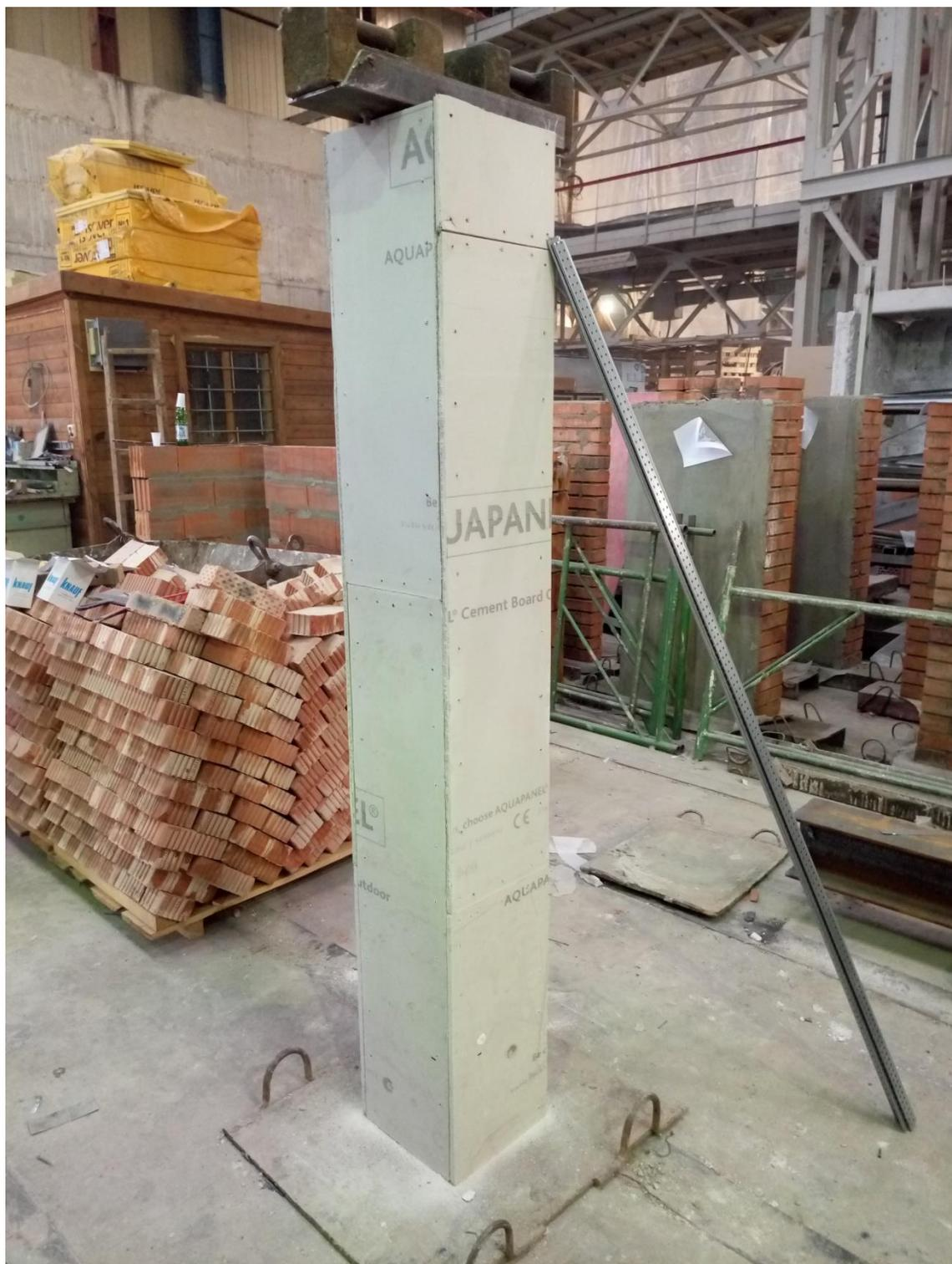
Рисунок 7. Экспериментальный образец, обшитый цементно-минеральными плитами АКВАПАНЕЛЬ® Наружная толщиной 12,5 мм
