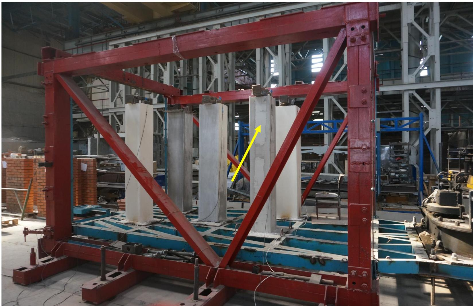
Рисунок 8. Экспериментальный образец колонны, обшитый цементно-минеральными плитами АКВАПАНЕЛЬ® Наружная производства фирмы «КНАУФ»
