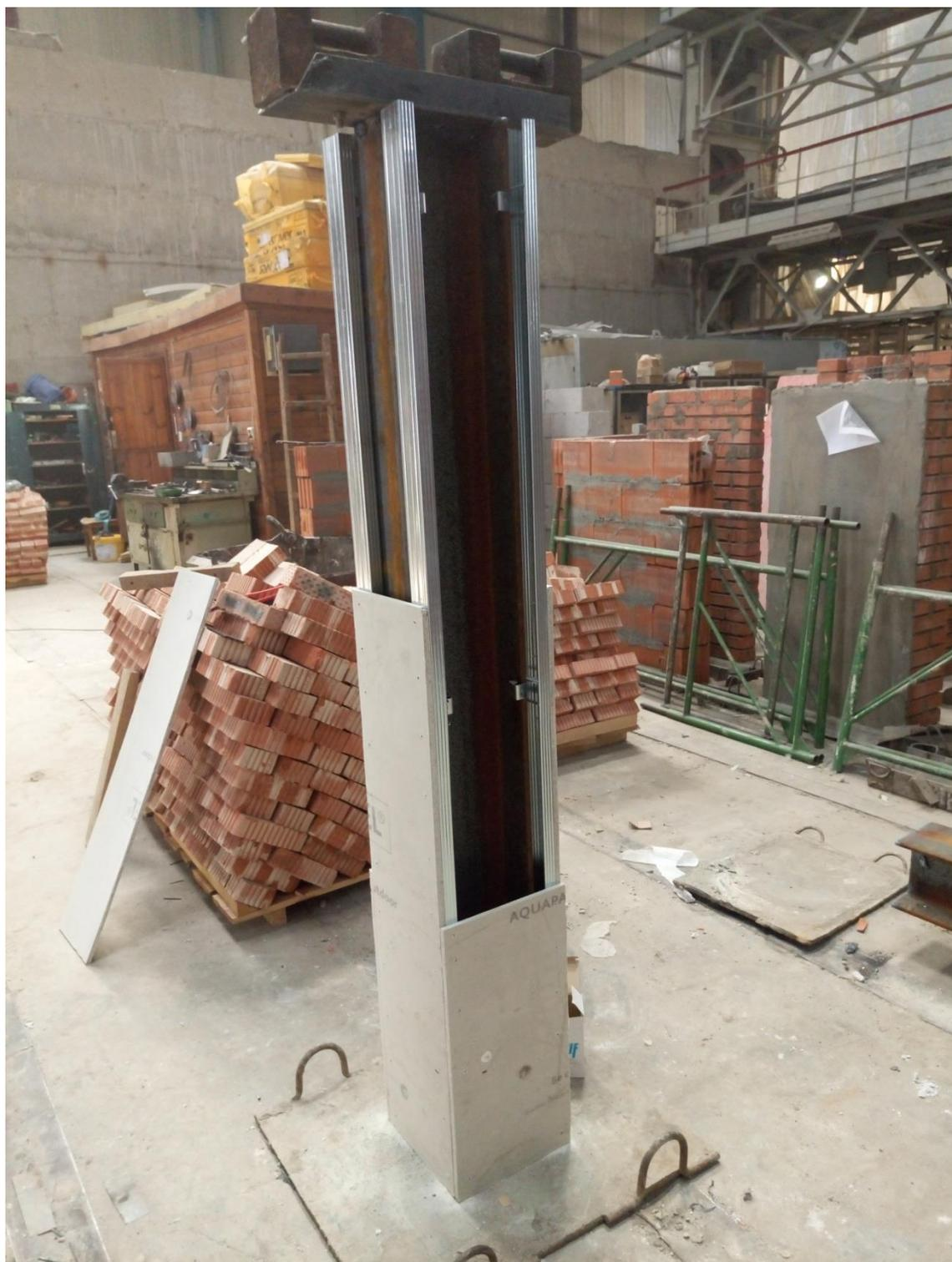
Рисунок 5. Колонна с обшивкой из цементно-минеральных плит АКВАПАНЕЛЬ® Наружная толщиной 12,5 мм
